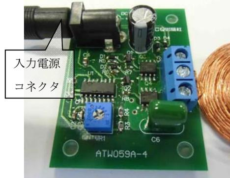
写真 3-1 受電基板のコイル接続方法
